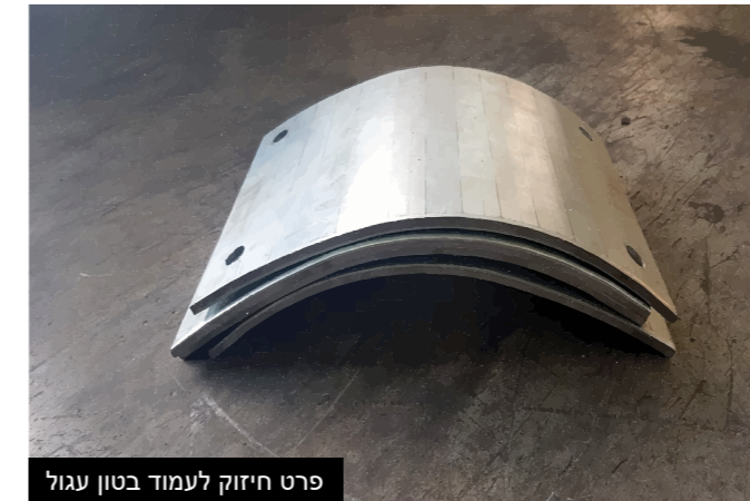
טכנולוגית כיפוף הפח מבוצעת ע"י מערכת CNC ממוחשבת
