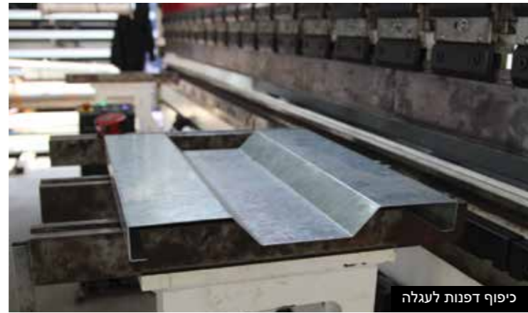
חיתוך וכיפוף פח בדגמים וצורות באמצעות טכנולוגית כיפוף מתקדמות.
