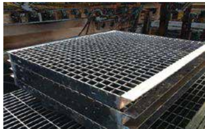
סבכה A60 בתוספת זוויות בצדדים להנחה עילית על הפתח שטוח גובה 50 עובי 4 מ"מ עגול כל 60 מ"מ רוחב 980 מ"מ אורך 1100 מ"מ
